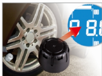
Sensores enviam dados continuamente para o módulo de controle, via wireless
