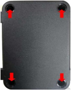
1 – Retire os parafusos e abra a caixa. É necessário aplicar um pouco de força. Atenção para não romper o cabo da bateria interna.
