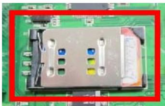
Abaxe a bandeja e encaixe novamente até que fique firme. Se o encaixe não ocorrer, poderá haver falha na leitura do SIM CARD durante movimento do veículo.
